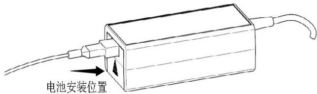
产品标配 7.4V/950mAh 两块锂电池，如上图所示：电池安装位置，本设计在插入衰减器后，衰
