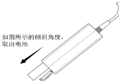
OPB6000 系列光隔离探头，采用独特的双电池可更换技术，保证客户可以不间断地测量。使用标准的卡片数码相机锂电池，在产品使用几年后若电池失效，客户可以自己购买该通用充电电池，而不需要寄回原厂更换。尤其是海外客户，没有这个烦恼。
